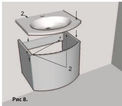
Прикрепить тумбу к стене при помощи кронштейнов, навесов или технологических отверстий. Нанести силиконовый герметик в местах примыкания раковины к тумбе и к стене. Установить и выровнять раковину на тумбе.
