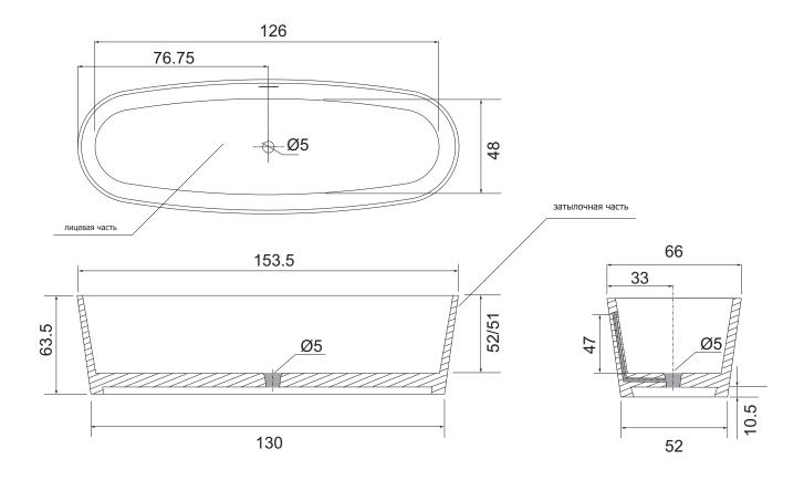
Толщина стенок монолитных ванн варьируется от 20мм до 45мм. Толщина дна монолитных ванн варьируется от 25мм до 45мм.
