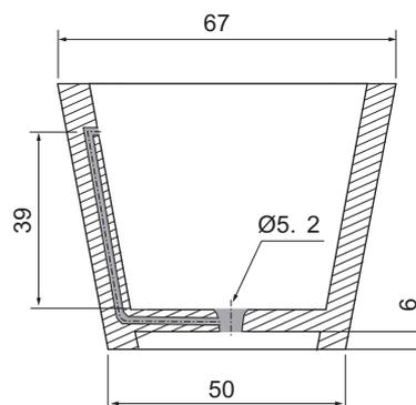
Толщина стенок монолитных ванн варьируется от 20мм до 45мм.
