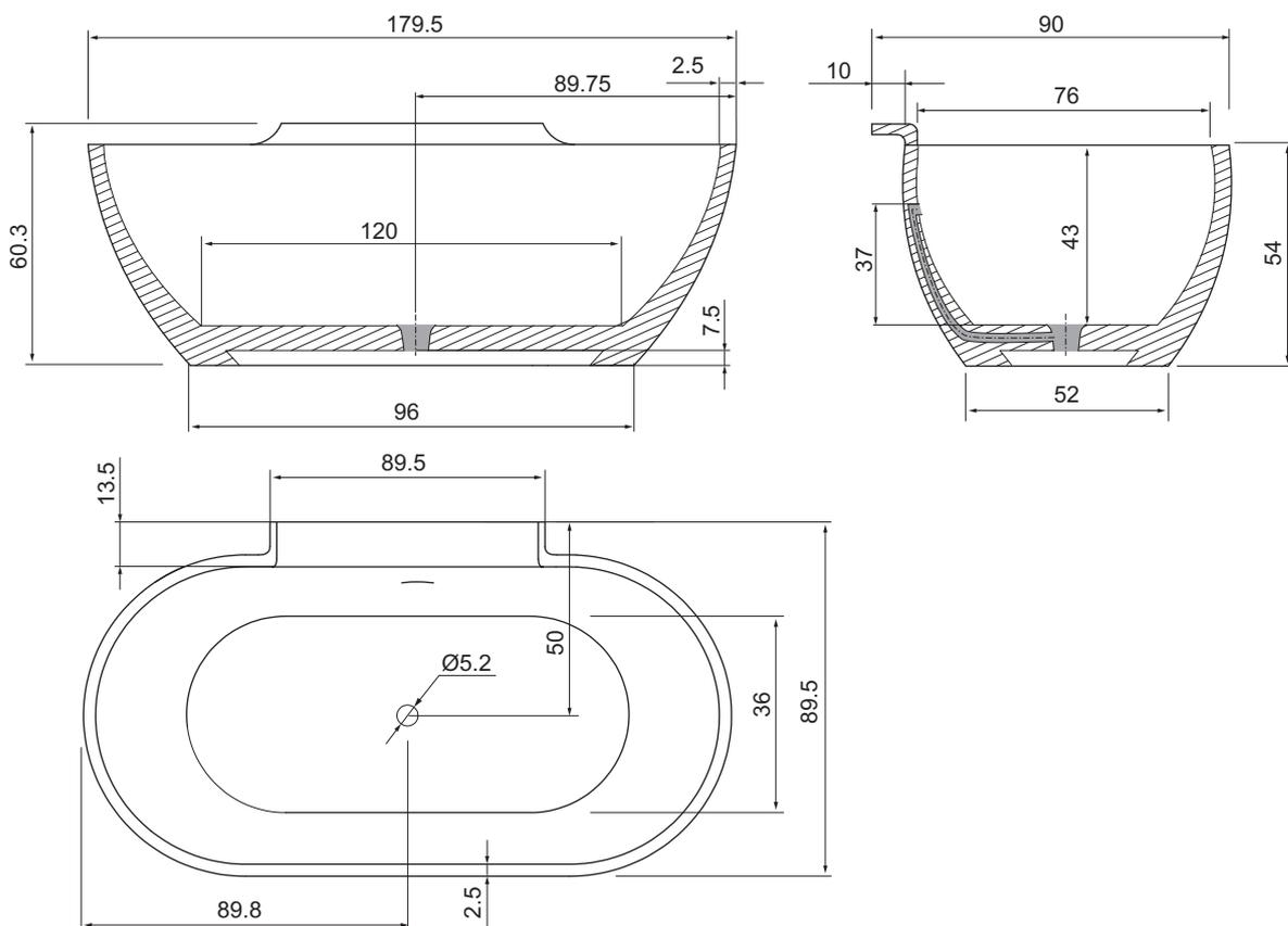
Толщина стенок монолитных ванн варьируется от 20мм до 45мм.
